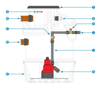
A Float bracket for optional high level alarm mini float.
